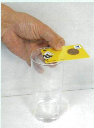
② コップを水で満たすと、カード下面が水に触れ、その水の表面張力によりカードも、その上に載っている10円玉も落ちません。
