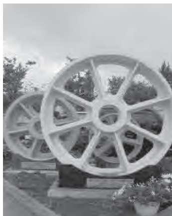
(右)東京スカイツリーエレベータ納入滑車 (左)虎ノ門ヒルズエレベータ納入滑車
